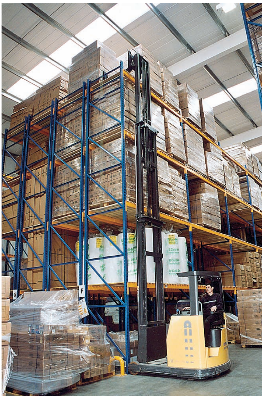
Pierwsza instalacja typu Double Deep w Polsce
